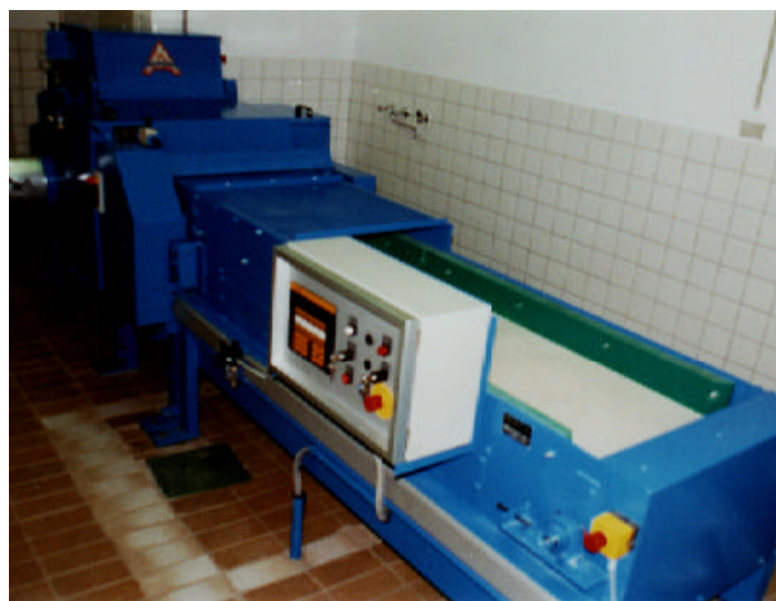
Bild 2: Ansicht der Laborreißanlage von der Materialeinlaufseite her
