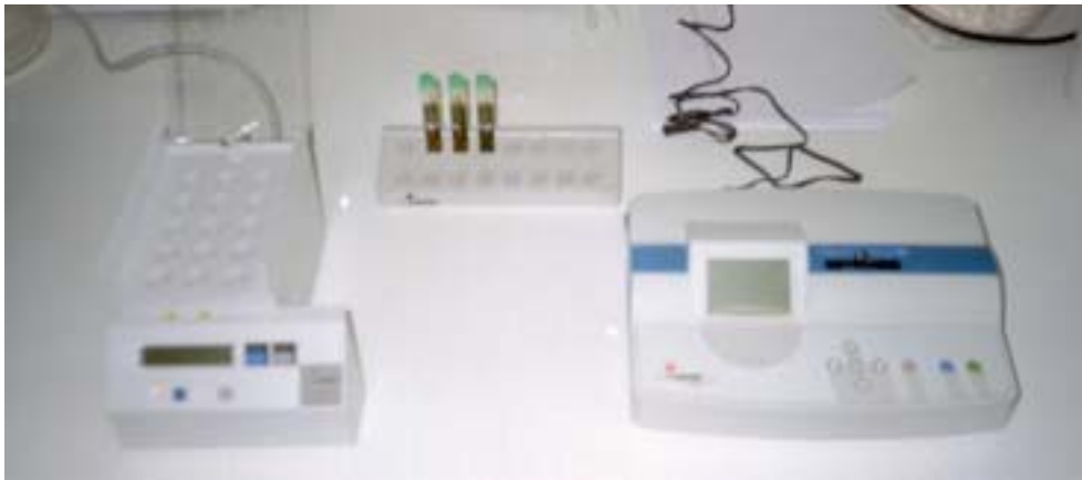
Abbildung 18: Ansicht der verwendeten Geräte für die CSB-Bestimmung (links LT 100, Mitte Küvetten, rechts Lasa 100)
