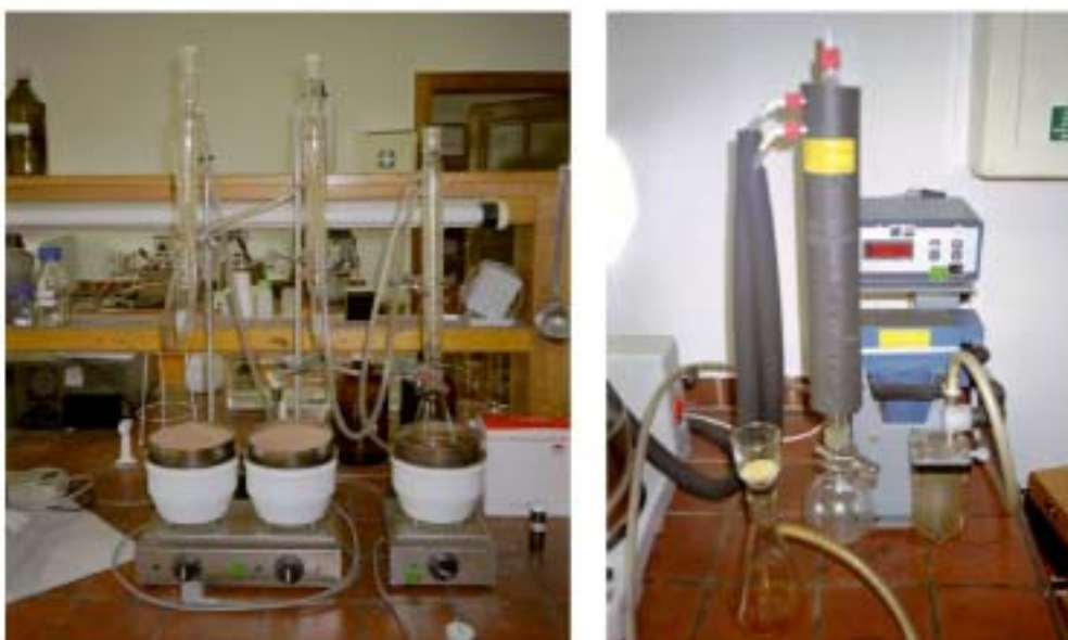
Abbildung 16: Ansicht des Nitriergerätes und der Vakuumpumpe
