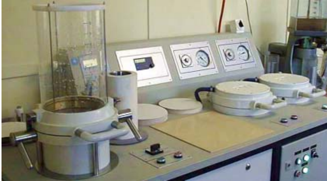
Abbildung 10: Ansicht des Blattbildners mit Blatttrocknungsanlage
