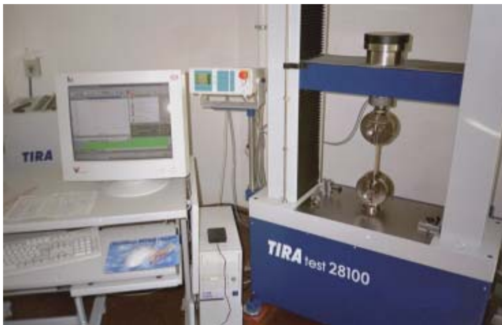
Abbildung 19: Ansicht des Arbeitsplatzes für die Zugfestigkeitsprüfung
