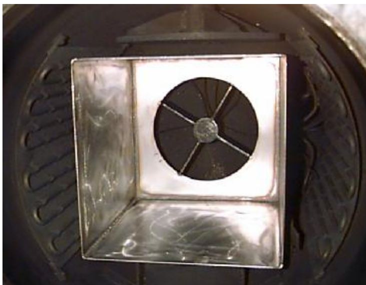
Abbildung 21: Temperaturmessfeld Charge / Funktionsprinzip der Heißgasumwälzung
