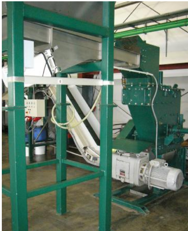
Abbildung 17: Prallwerk mit Vibrationsförderer, Auswurf und Magnetabscheider
