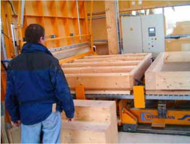
Abbildung 21: Einlauf der Wandbauteile (Versuchselemente).
