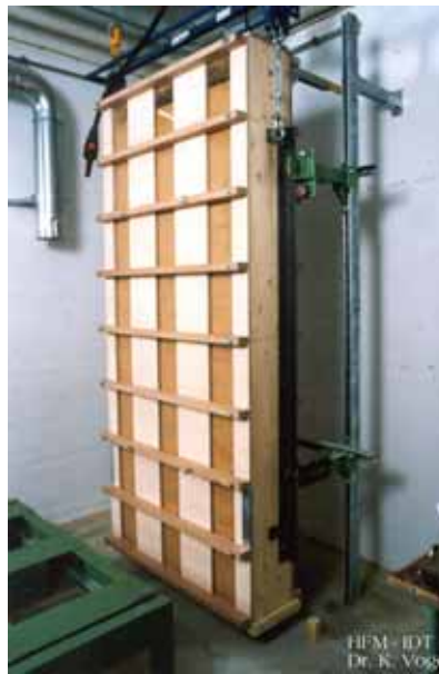
Abbildung 14: Versuchseinrichtung zur Durchführung von Setzungsversuchen mit Wandbauteilen.
