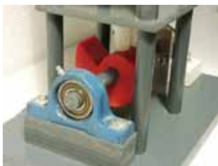
Abbildung 10: Messgerät zur Ermittlung des Setzungsverhaltens im Kleinversuch. Ein mit Motor betriebener Exzenter hebt das Prüfgefäß in einer Führung senkrecht um 33 mm an und lässt es dann im freien Fall auf eine harte Auflage aufschlagen.
