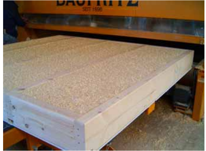
Abbildung 22: Auslauf der gefüllten Wandbauteile.
