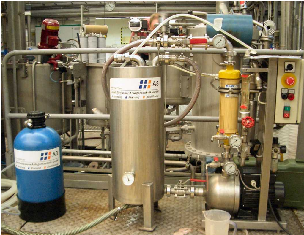
Abb. 1: Ultrafiltrationsanlage mit nachgeschaltetem Aktivkohle Drucktank
