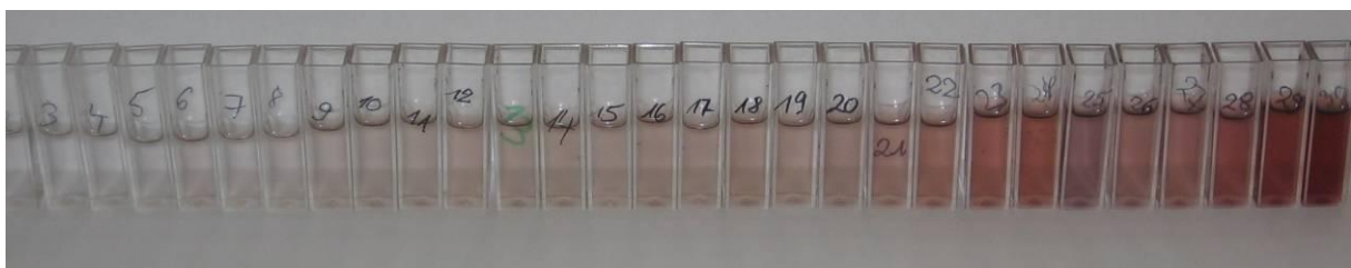
Abb. 9: Farbreihung Permeat in einem Versuch mit Membran Koch MPF 34 (Ausbeute 0% - 95 %)
