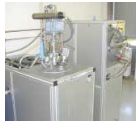
Bild 3: Pilotanlage zur Herstellung von Modellwachs-Produktmustern (25 kg/d)
