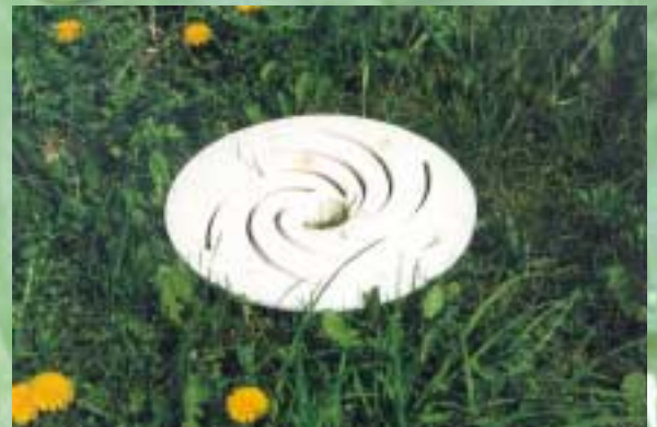
Umweltfreundliches Wasserglasverfahren – Kern für Schaufelrad
