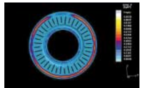
Bild 3: Graphisches Simulationsergebnis am Beispiel einer Brems-scheibe
