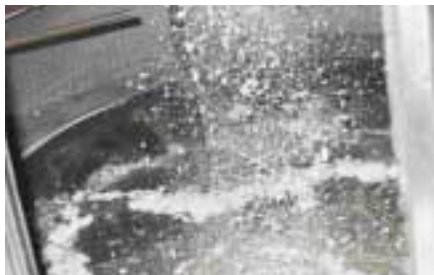
Bild 2: Die Abdeckung der Mg-Schmelze mit \text{CO}_2 -Schnee bei 700^\circ\text{C} (Beschneigung)
