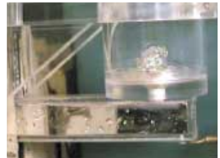
Bild 1: Foto eines Modellexperimentes mit der bei Raumtemperatur flüssigen Schmelze InGaSn. Die kalte Modellströmung kann mittels Ultraschall lokal ausgemessen werden
