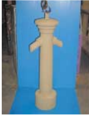
Kern Wasserglas-CO 2 für Hydrant
