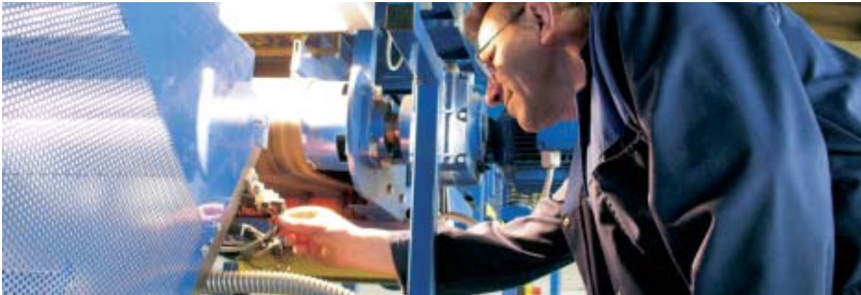
Einstellen der Düsenkanäle zum Ausblasen der fraktionierten Kunststoffpartikel
