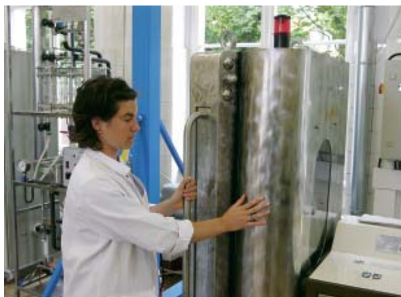
Labor-Hochdruckanlage (0,75 ; 1 GPa) zur schnellen und schonenden Pasteurisation von Lebensmitteln
