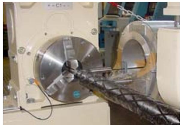
Wickelprozess von CFK-Rotorkomponenten
