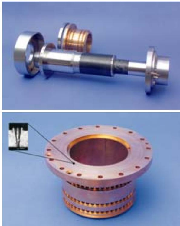
Oben: Verbundrotor und Lager-Anordnung. Unten: Axial-Radial-Luftlager mit laser-gefertigten Mikrodüsen
