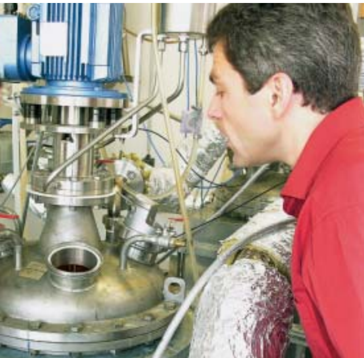
Reaktor der kleintechnischen Versuchsanlage
