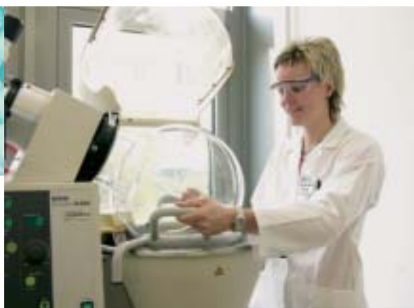
Destillative Wachsentwässerung im Rotationsverdampfer
