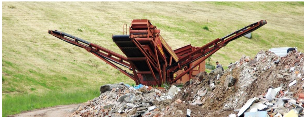
Abbildung 1: Mobile Aufbereitungsanlagen für Bauschutt (Bildquellen oben & unten: Jochen Zellner, Landkreis Neustadt/Aisch-Bad Windsheim, www.abfallbild.de )
