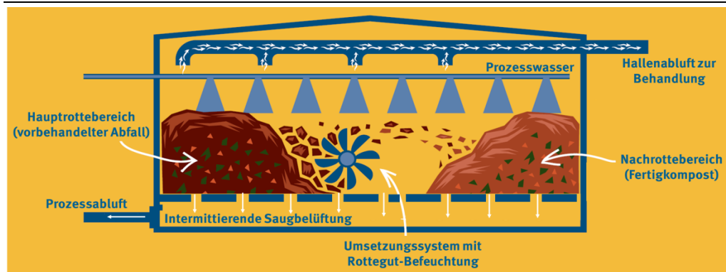
Abbildung 2: Verfahrensschema Hallenkompostierung mit Tafelmiete (Komponentenanordnung n. Linde KCA)
