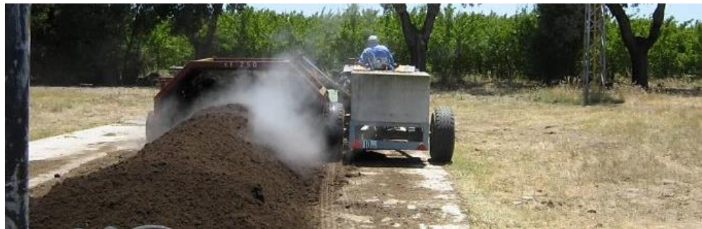
Abbildung 1: Beispiel für aktive Belüftung über dynamisches Verfahren mit Umsetzung (Bildquelle: Intecus)
