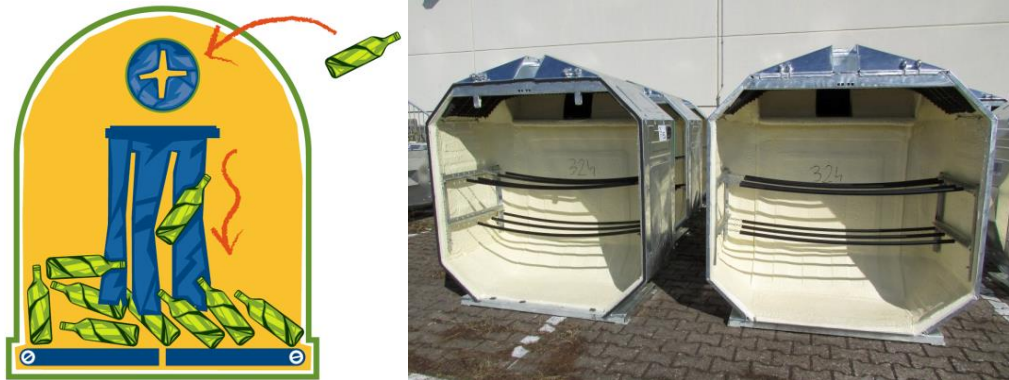
Abbildung 3: Querschnitt eines Depotcontainers mit Fallbremse und Schalldämmmatte (Bildquelle rechts: Harald Heinritz, www.abfallbild.de )
