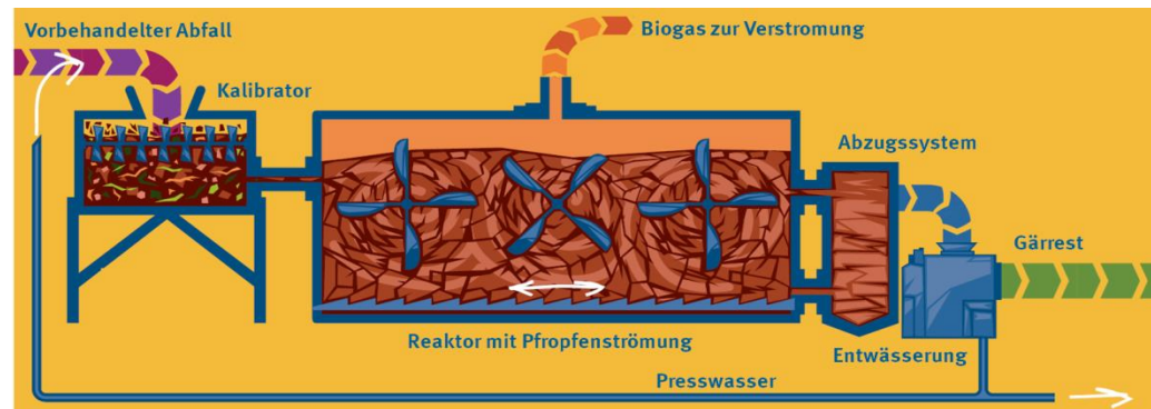
Abbildung 3: Verfahrensschema einstufige Trockenvergärung (Komponentenanordnung nach Linde-KCA)
