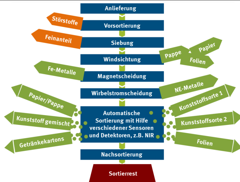
Abbildung 3: Beispielhafter Sortierprozess für Kunststoffsorten (erweiterte Konfiguration)
