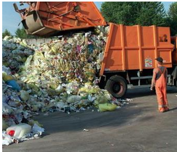
Abbildung 3: Entleerung von Hecklader über Pressplatte (links, rechts) (Bildquelle links: Intecus GmbH, Bildquelle rechts: Petra Hoefß, FABION Markt + Medien, www.abfallbild.de )
