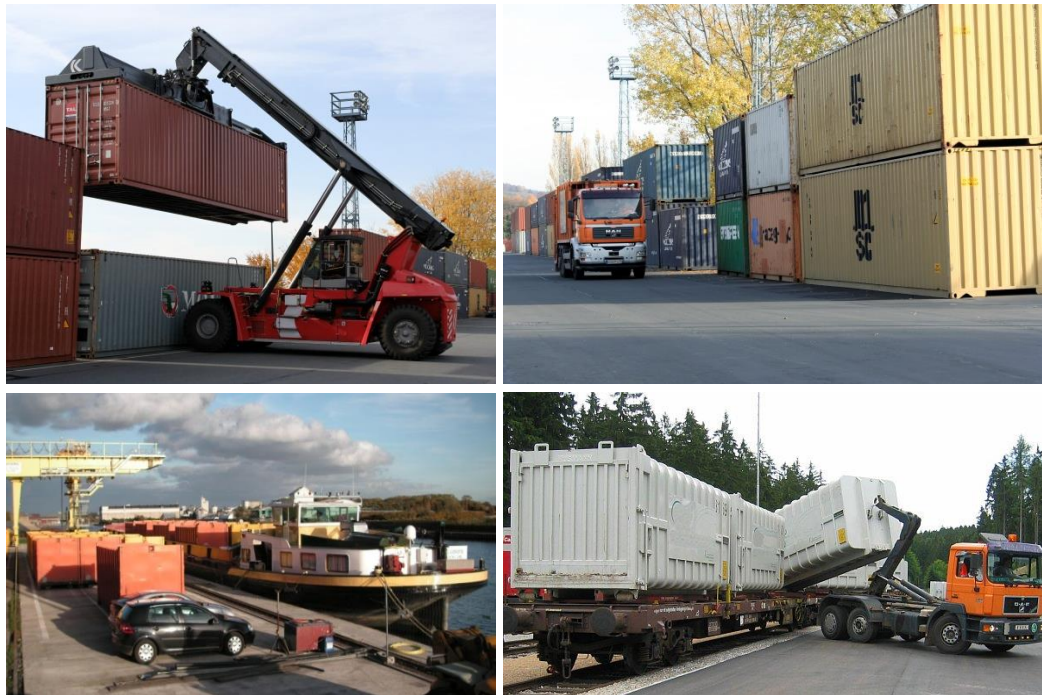
Abbildung 2: Wechselcontainer zum Straßentransport (links oben & rechts oben) (Bildquellen links oben & rechts oben: Petra Hoeß, FABION Markt + Medien / www.abfallbild.de ) / Umladestation für Wechselcontainer zum Schiffstransport (links unten) und Bahntransport mit dem Abroll-Container-Transport-System bzw. ACTS (rechts unten) (Bildquelle links unten: INTECUS GmbH / Bildquelle rechts unten: Autor: Priwo, Lizenz „Creative Commons Attribution/Share Alike“)
