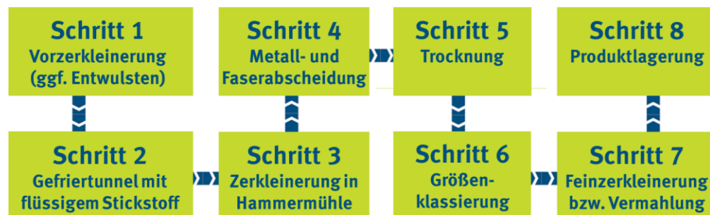
Abbildung 2: Beispiel einer Prozessanordnung zur Kaltvermahlung von Altreifen
