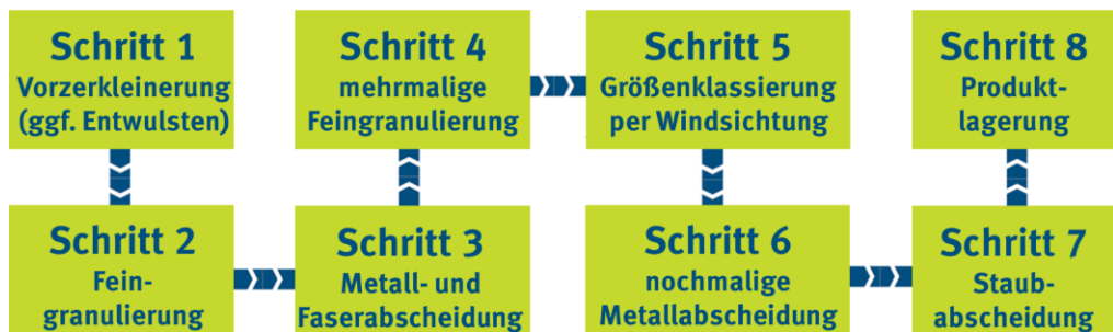
Abbildung 1: Beispiel einer Prozessanordnung zur Warmvermahlung von Altreifen
