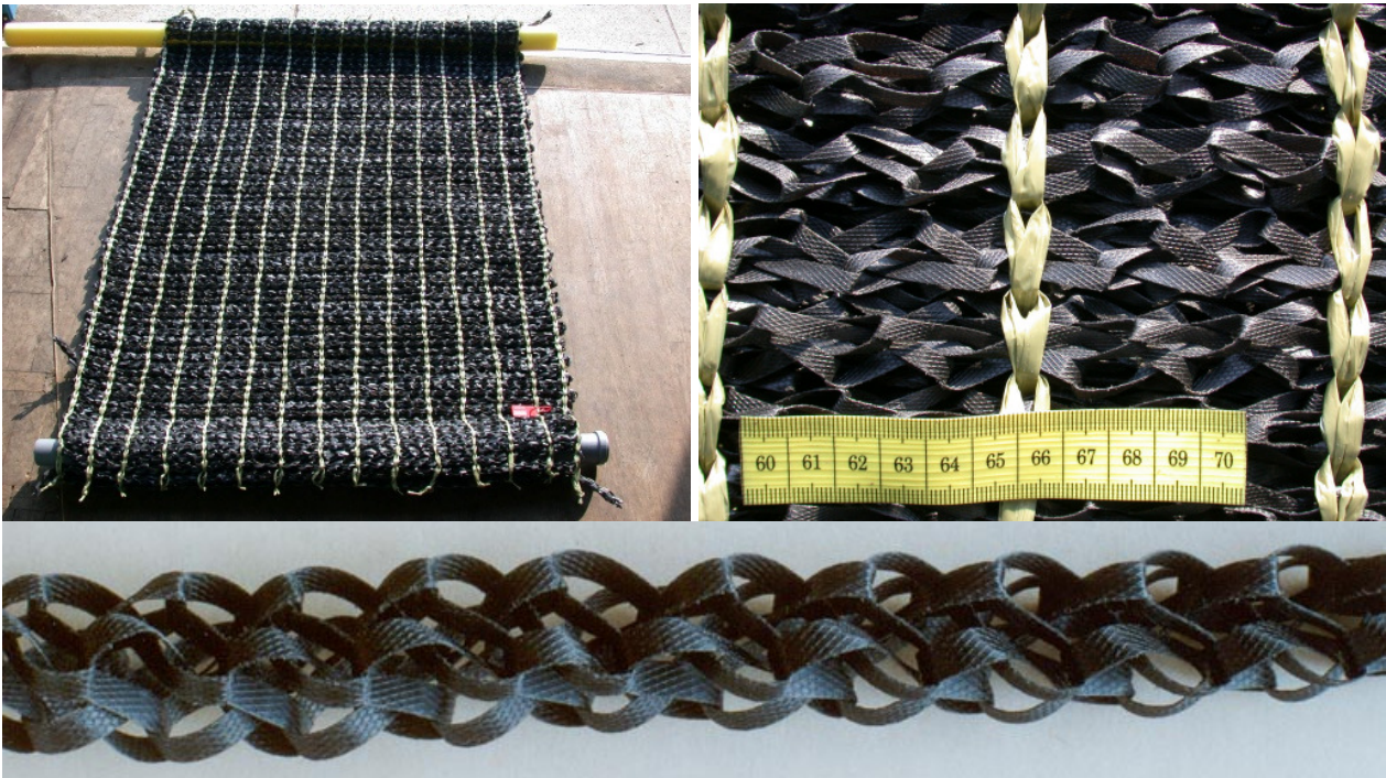
Abbildung 1: (links) Modul (Breite 1000 mm, Länge 1500 mm) der hydraulischen Barrieren aus extrem grobem Rechts-Rechts-Kettengewirke. Rechts Detailansicht mit Schlingenseilstruktur (unten) aus Polypropylen-Bändchenmaterial
